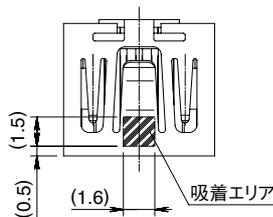
◆推奨ランドパターン寸法図 (取り付け面側)
