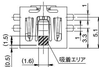
◆推奨ランドパターン寸法図 (取り付け面側)
